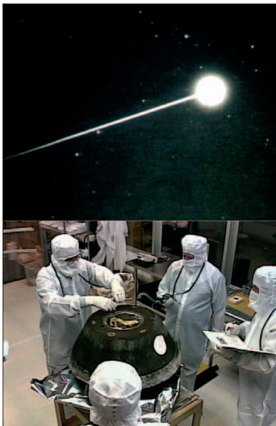
Figura 3. Arriba, el bólido artificial producido por la deceleración en la atmósfera terrestre durante la reentrada de la cápsula de retorno. (Stardust/NASA). Abajo, en una sala limpia temporal los científicos a punto de abrir la cápsula recién recuperada. (NASA TV)
