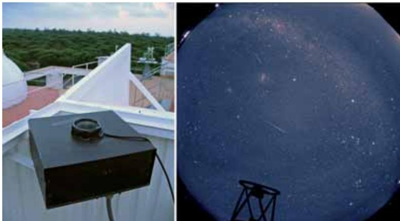
Figura 2. Izquierda) La cámara de todo el cielo CASANDRA-1 en la Estación BOOTES-1 en la Estación de Sondeos Atmosféricos del Centro de Experimentación de El Arenosillo del INTA en Huelva. Derecha) A modo de ejemplo, imagen del cielo austral obtenida con otra cámara similar (CASANDRA-3) en el Observatorio Robótico BOOTES-3 en Blenheim (Nueva Zelanda) mostrando dos meteoros en una imagen de 40 segundos de tiempo de integración, revelando el potencial de dicho instrumento.
