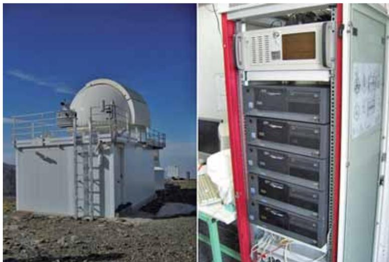
Figura 4. A la izquierda de la imagen, ubicación de la estación automática de detección de meteoros del Observatorio de Sierra Nevada, operada por la Universidad de Huelva y el Instituto de Astrofísica de Andalucía. A la derecha se muestra el sistema de control de los dispositivos CCD de vídeo que operan desde esta estación.
