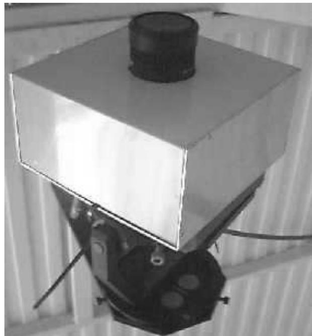
Figura 1 — La naturaleza compacta y ligera de la cámara CCD de todo el cielo aquí descrita permite su fácil instalación en una gran variedad de emplazamientos, como la situada originalmente en noviembre de 2002 en la estación astronómica donde se ubican los telescopios robóticos del Proyecto BOOTES en el Centro de Experimentación del Arenosillo del INTA.
