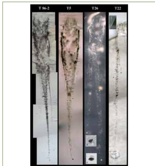
**Figura 8.** Algunos de los túneles excavados por las partículas del cometa 81P/Wild 2 durante su captura en el aerogel. Los tres primeros son de tipo B mientras que el último (T22) es de tipo A. Las partículas penetraron en el aerogel desde arriba (Stardust/NASA).
